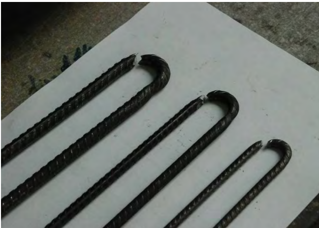
Particolari della rottura dei provini in B450A testati a trazione dopo la piegatura
